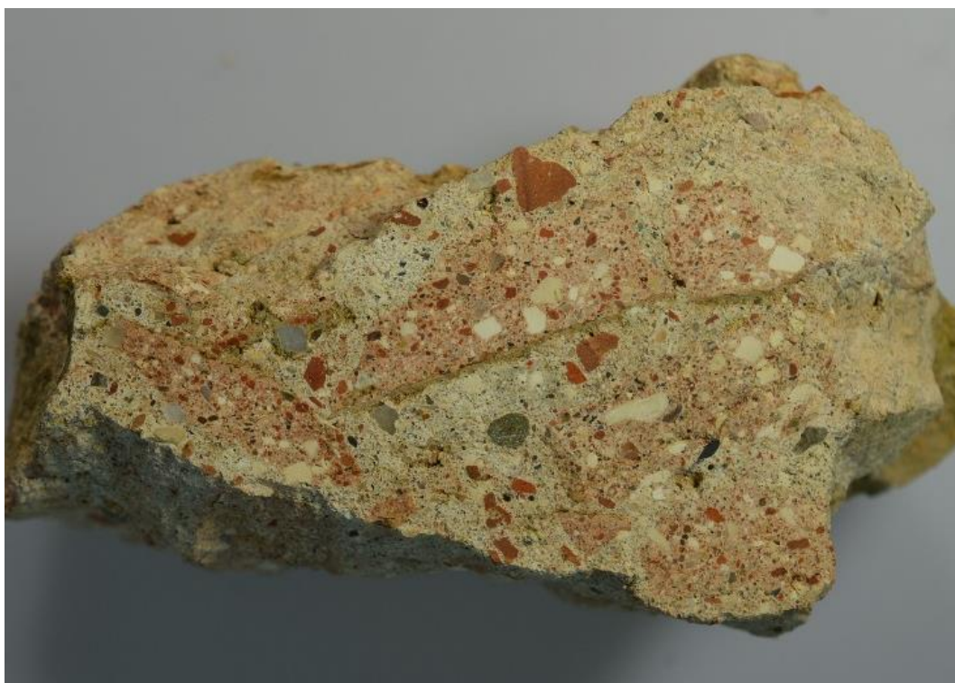
Obr. 15 Broušený řez maltou zaniklé podlahy na terase sala terreny SZ Lysice. V maltě jsou patrné úlomky starší maltové podlahy.
