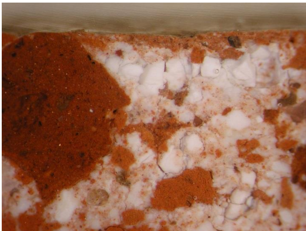
Obr. 11 Nábrus maltou z podlahy dochované na SH Švihov. Vlastní povrch podlahy o tloušťce cca 1 mm je světle růžový. Na obrázku nahoře
