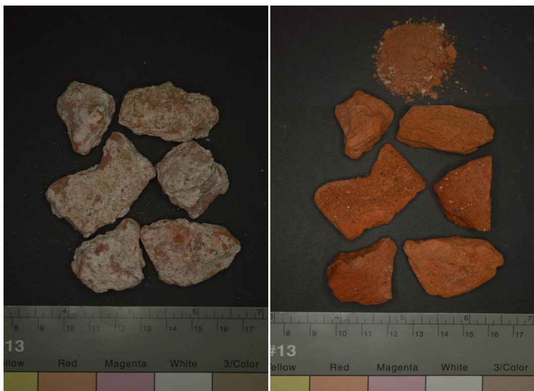
Obr. 8 a 9 Úlomky keramiky ve vápenné podlaze, severní palác SH Švihov. Úlomky před a po odstranění vápenného pojiva malty.
